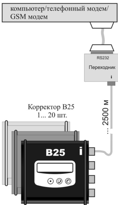
Оборудование сети корректоров B25 для передачи информации: телефонный модем (GSM модем) – для передачи по кабелю не требуется, переходник RS232 (или USB) и элементы приборного интерфейса: кабели и разветвители для подключения нескольких корректоров в случае необходимости.
